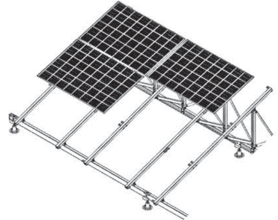
<ソーラーパネル設置例>
